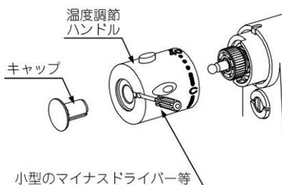
3. 温度調節ハンドルの目盛「40」が表示マークに合うように付け直します。
