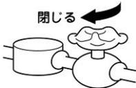
2. 切替ハンドルを吐水口側(下)全開にして水栓内部の圧力を抜く。
