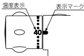
2. 切替ハンドルを『吐水口』側全開にして吐出温度を計る。
