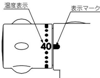
温度調節ハンドルを高温側(下)に回すと、安全ボタンの働きで目盛「40」を少し過ぎたところで一度止まります。お湯の温度を更に上げたい場合は、安全ボタンを押しながら回してください。
