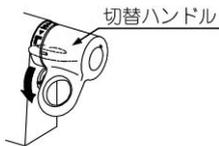
3. 大型のマイナスドライバー等でストレーナー付逆止弁を取り外し、ストレーナーのゴミ等を洗い流す。
