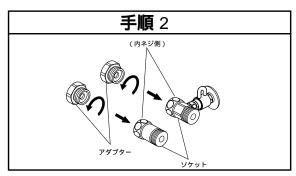
手順 2:取り外したアダプターをソケットの内ネジ側にネジ込んでくださ
