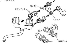
お願い: MYM(喜多村合金製)のツーバルブ混合栓、またはシングルレバー混合栓に取り付ける場合同梱の専用パッキンを(図A)のように分岐ソケットの内側に入れ取り付けてください。
