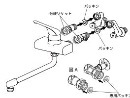
お願い: MYM(喜多村合金製)のツーバルブ混合栓、またはシングルレバー混合栓に取り付ける場合同梱の専用バッキンを(図A)のように分岐ソケットの内側に入れ取り付けてください。
