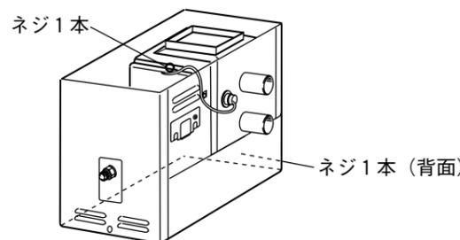
3.焚き口方向を変更し、逆の手順で取り付ける。(左焚きにした場合は、ハイリミットコードの取り出しも左側にする。)
