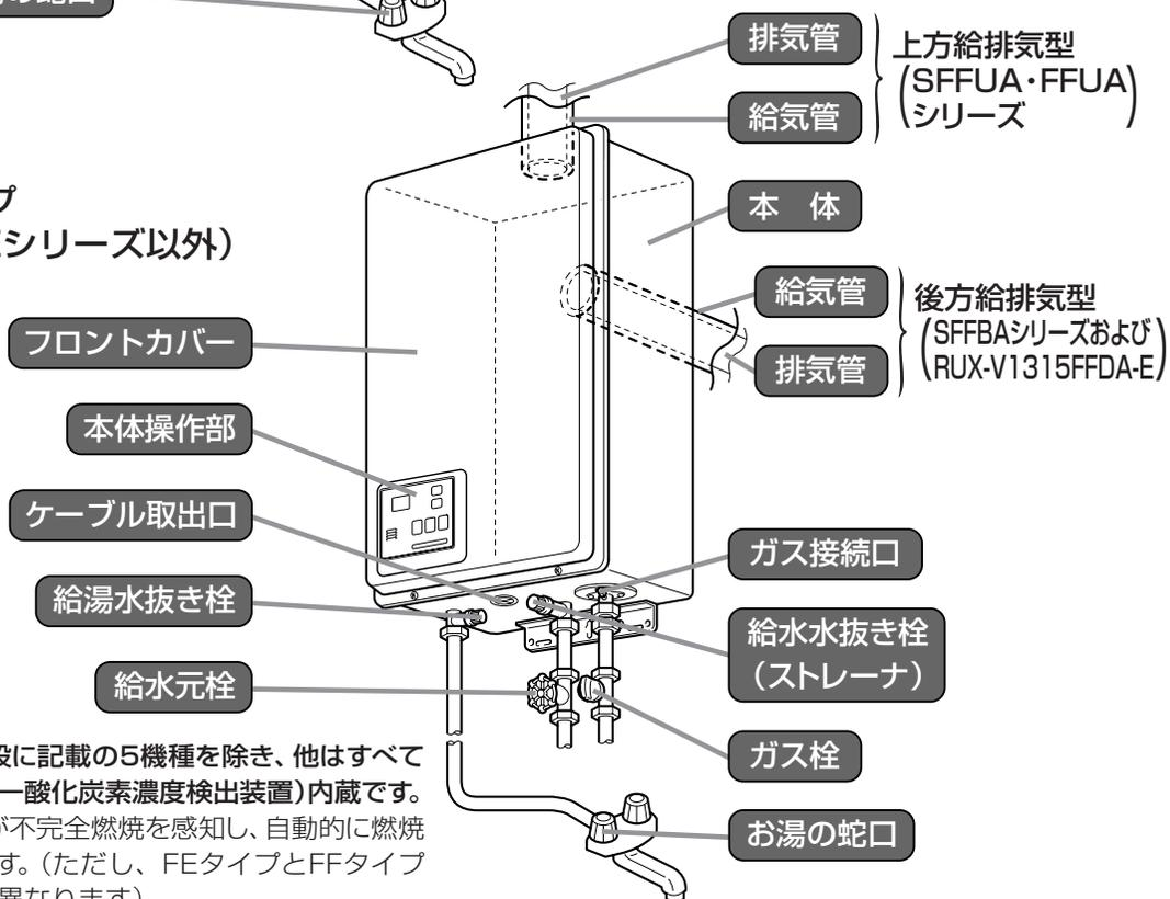
44ページ中段に記載の5機種を除き、他はすべてCOセンサー(一酸化炭素濃度検出装置)内蔵です。COセンサーが不完全燃焼を感知し、自動的に燃焼を停止させます。(ただし、FEタイプとFFタイプは作動条件が異なります)
