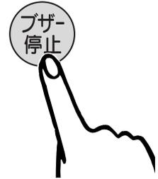
■MC-91-1は故障表示点滅時のみブザーが鳴り、「優先」スイッチを押すとブザー停止します。
