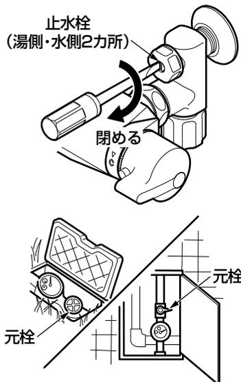
マイナスドライバーを差し込み、湯側・水側の止水栓を閉める。
