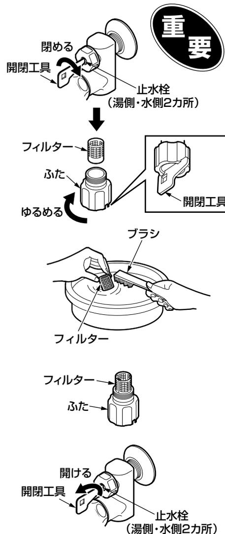
1. 開閉工具で湯側・水側の止水栓を閉める。
