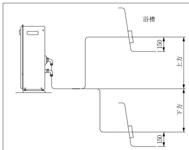
※「延長循環アダプタ」KGOP-LCA2000を使用したときは、2穴で2mまで延長可。それ以上の延長の場合は、「おいだき配管延長セット」AFP-500-15Aと1穴の循環金具を組み合わせてください。
